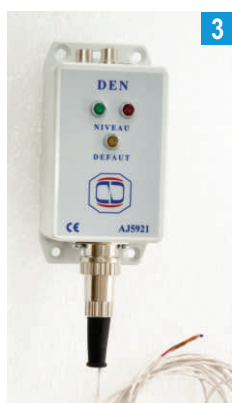
3. Устройство DEN сигнализации низкого уровня жидкого азота
