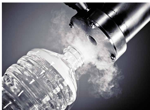
Впрыск жидкого азота на линии розлива на скорости до 45 000 бут/час
