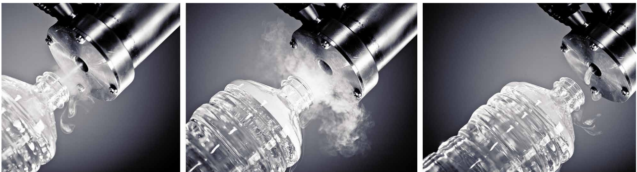
Прецизионный впрыск дозы жидкого азота в каждую бутылку со скоростью до 45 000 доз в час
