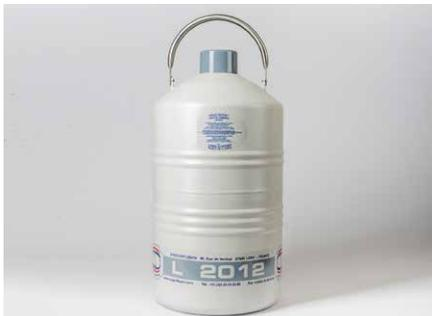
Предназначен для хранения и транспортировки жидкого азота объемом 12 литров. Сосуд Дьюара это большой «термос» или «сосуд в сосуде» специальной конструкции, который имеет узкую горловину и экранно-вакуумную изоляцию межстенного пространства для минимизации потерь жидкого азота от испарения.
