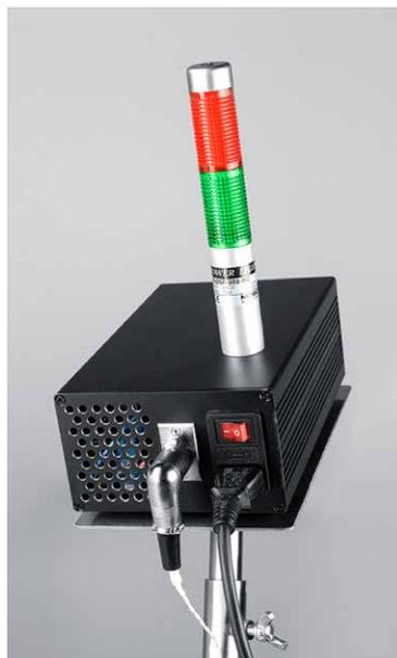
CryoLTM-12 осуществляет измерение и индикацию (мониторинг) уровня жидкого азота и температуры в режиме онлайн с помощью двух датчиков температуры RT1000, предварительно смонтированных на разных уровнях по высоте, и измерительного модуля на базе терморегулятора 2TPM1 со световой и звуковой сигнализацией.
