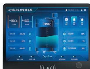
Блок управления и контроля Cryosmart на базе Android предназначен для контроля уровня жидкого азота внутри криохранилища, управления процессом дозаправки, контроля температуры вверху и внизу криохранилища и др.
